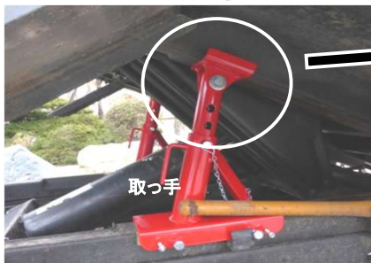
DS-700S用アタッチメント付装着時 (2TONダンプ受木使用例)
